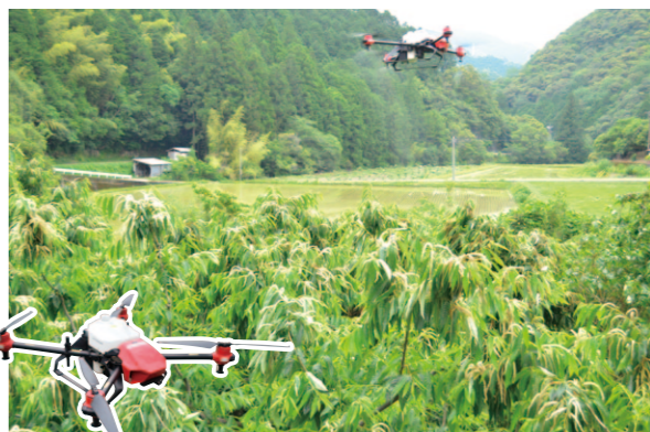
風を起し旋回しながら散布するので枝が揺れています。
