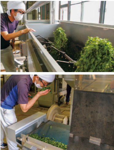
JA佐川緑茶加工場。収穫した生葉は、蒸す、乾かす、揉むなどといった工程を経て「荒茶」の状態まで加工されます。同じラインで釜炒り茶、紅茶、烏龍茶が製造可能。1つのラインで4種類を製茶できるのは全国的に珍しいことです。
