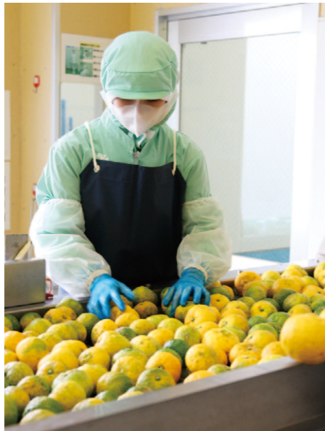
作業員がベルトコンベアの上で、傷みをチェックし選別。その後、きれいに洗われてから搾り作業に入ります。
