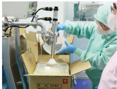
搾ってきれいに濾された果汁は、18.5kgの容器に充填して冷凍保存。搾りたての風味と香りを閉じ込めます。れいほく柚子加工場では、例年6,000ケースほどの果汁が搾られます。
