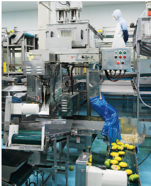
1玉1玉機械に入り、果汁と皮に分けられます。皮の一部は、「ユズ皮」として出荷されます。
