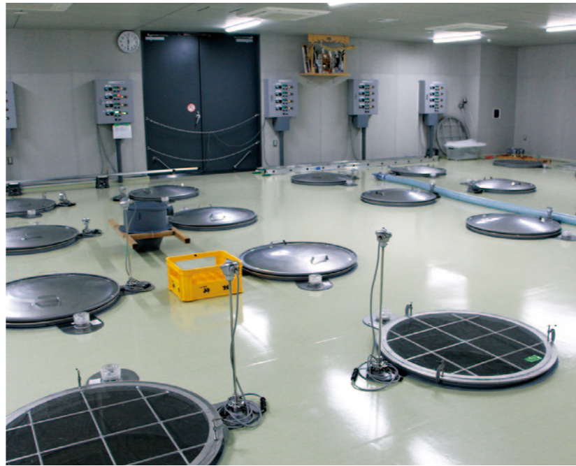
仕込み室。仕込みタンクの温度管理もデジタルで調整。24時間、最適な温度・湿度に管理されています。
