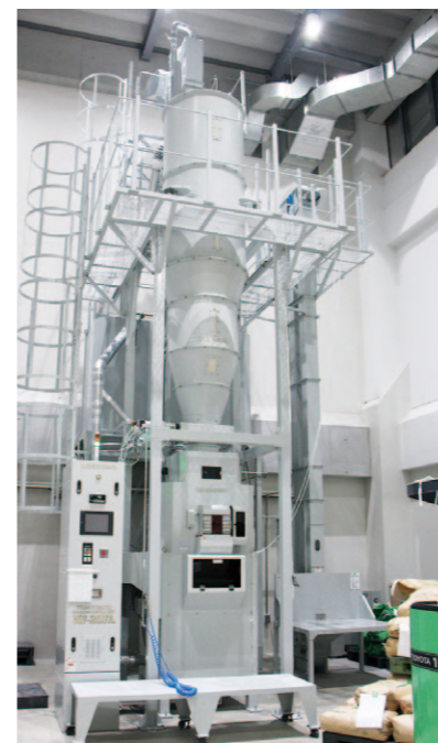
1,800kgを精米可能な巨大精米機。酒造好適米を精米歩合50~30%まで磨きあげます。
